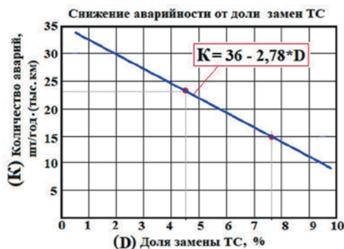
Рисунок 2. Зависимость интенсивности потока отказов (K) тепловых сетей РФ от доли замены (D)
