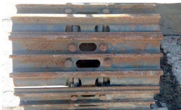
Рисунок 4. Гусеницы дорожной и лесной техники: а) гусеница экскаватора — 600 мм; б) гусеница лесной машины — 700 мм Figure 4. Crawler tracks of road and forestry machines a) excavator track — 600 mm; b) forestry machine track — 700 mm
