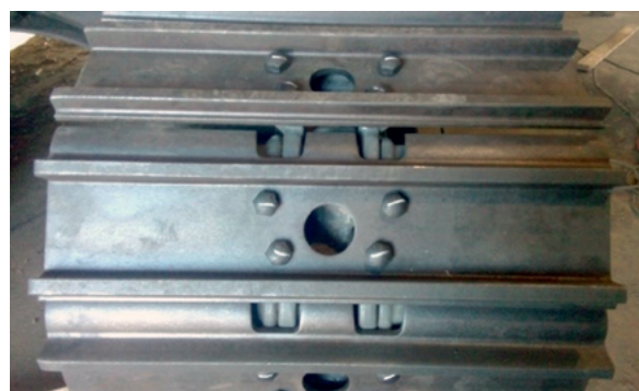
Рисунок 4. Гусеницы дорожной и лесной техники: а) гусеница экскаватора — 600 мм; б) гусеница лесной машины — 700 мм Figure 4. Crawler tracks of road and forestry machines a) excavator track — 600 mm; b) forestry machine track — 700 mm
